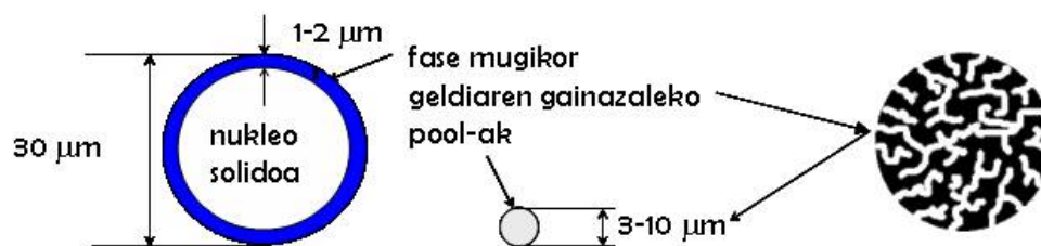
Irudia 3.2: Likido-kromatografiako paketatze zutabeetan erabiltzen diren pelikuladun partikulak eta partikula mikroporotsuak.
